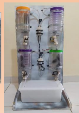
Bancada didática do processo de quatro tanques acoplados
