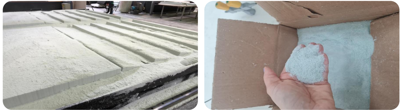
Figura 2. Espuma PET utilizada como núcleo estrutural de pás eólicas em Suape-PE: (a) Espuma de PET sendo usinada em máquinas CNC. (b) Pó da espuma de PET coletados no sistema de exaustão das máquinas CNC
