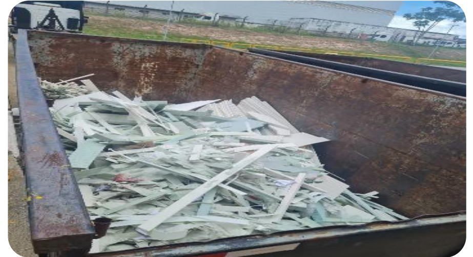
Figura 1. Resíduo de espuma PET do núcleo estrutural de pás eólicas gerados na empresa SIW parceira do projeto, destinados em aterro sanitário: (17 t/mês).
