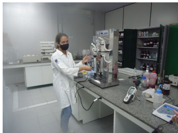
Figura 66: Destilador de Nitrogênio
