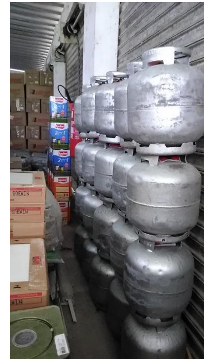
Figura 48: Armazenamento de botijões inadequado
