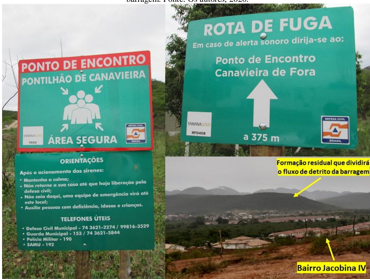
Figura 6 – a/b) Placas de sinalização para a rota de fuga e pontos de encontro em caso de rompimento das barragens; c) Localização da formação residual que dividirá o fluxo de detrito num eventual rompimento da barragem. Fonte: Os autores, 2020.
