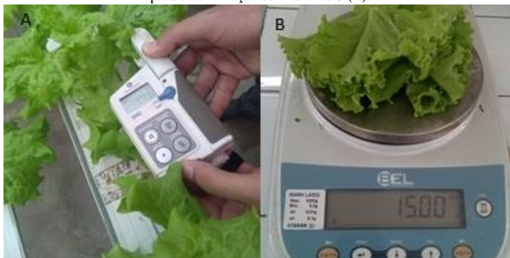
Figura 2. Determinação dos teores de clorofila através do SPAD- 502 (A), pesagem de 15 g de massa fresca para determinação de vitamina C (B).
