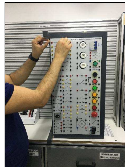
Foto 2: Sala E8 – Painel de comandos elétricos e partida de motores.
