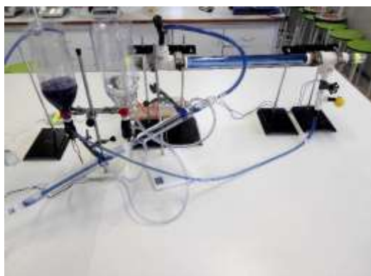
Figura 2 – sistema de oxidação avançada para redução da cor de efluentes têxteis.
