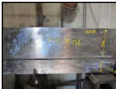
Figura 1 – Montagem das chapas para confecção da junta soldada.
