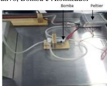
Figura 1 – Montagem Interna do Resfriador Evaporativo, Bomba e Atomizador
