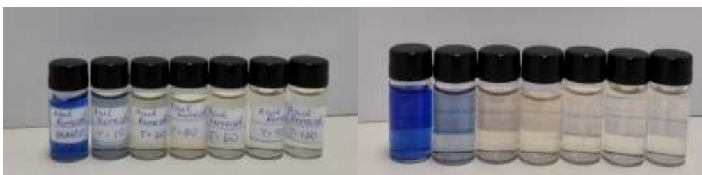
Figura 2 – Teste de degradação realizado com 0,25mL H 2 O 2 e 0,25g NaOH no reator construído
