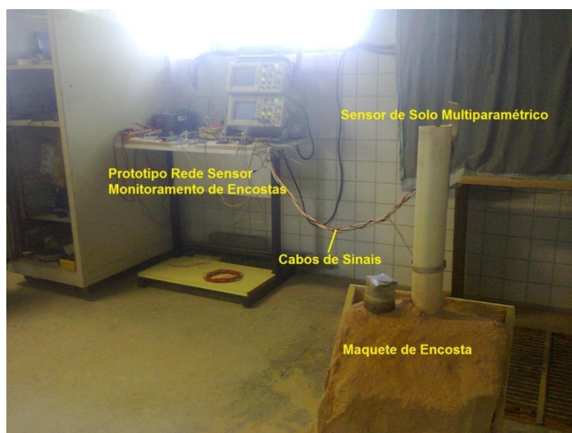
Figura 11: Detalhes da conexão do Sistema Rede Sensor de Encosta a amostra de solo sob simulação e
