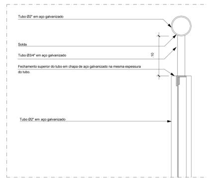
**12** DETALHE 09 - CORTE AA - FIXAÇÃO SUPERIOR DO GUARDA-CORPO
