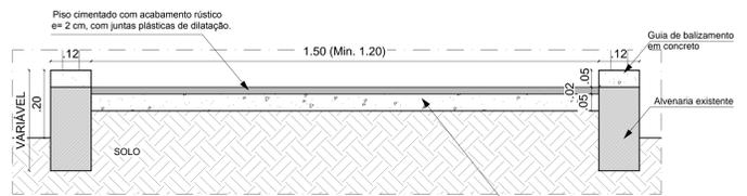
**07** DETALHE 04 - CORTE TÍPICO TRANSVERSAL DE RAMPA E CIRCULAÇÃO (MANTENDO A LARGURA EXISTENTE) - GUIA DE BALIZAMENTO EM CONCRETO
