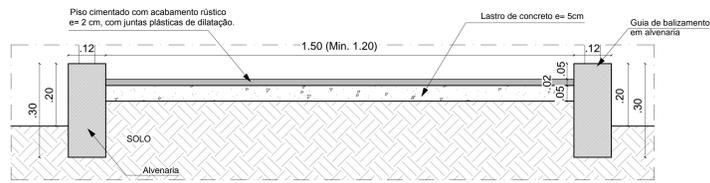
**06** DETALHE 03 - CORTE TÍPICO TRANSVERSAL DE RAMPA E CIRCULAÇÃO (COM ALARGAMENTO) - GUIA DE BALIZAMENTO EM ALVENARIA
